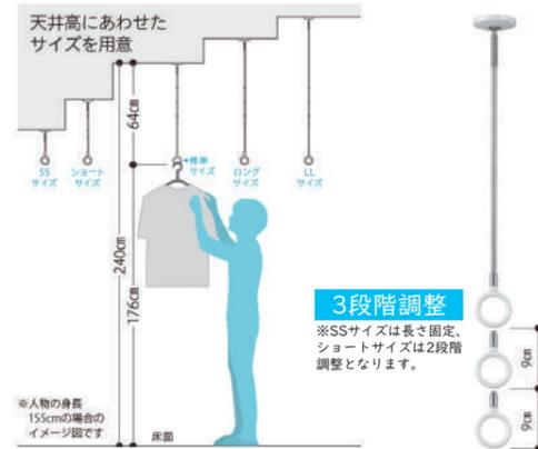
ポールは軽くて持ちやすく、穴にさし込んで回転させるだけのワンタッチ着脱。回転する際には「カチッ」という手応えのある音とともに、しっかりロックされます。ポールを外す際は、上に押し当てて回転させないとロックが解除されない安全構造。ポールの脱落を防ぎます。
